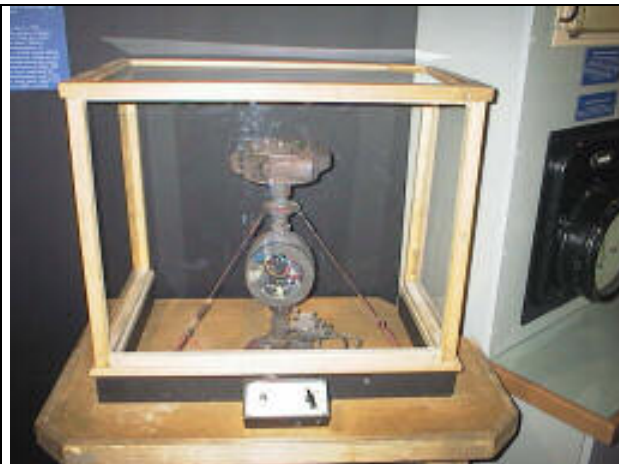
Riproduzione funzionante dell'anemometro che registrò il vento a 372 km/h
